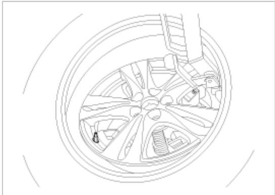
4. 底部胎圈位于轮胎上后，转动轮辋直到气门在相对轮胎更换器头部的5点钟位置。向下按压3点钟位置上的轮胎并顺时针转动轮辋以装配顶部胎圈。
